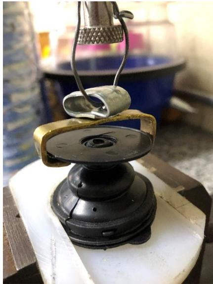
3. Rotacionar a alavanca puxadora no sentido de extrair a base do Pop Socket do fole. Observar a marcação no mostrador analógico ( $\pm 5\text{Nm}$  ou  $0,500\text{Kg/f}$ ).
